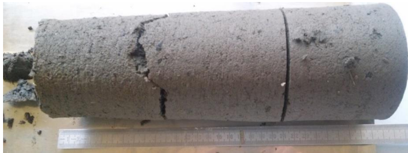
Figure 5. Carotte sortie de la cellule de filtration en fin d'essai
